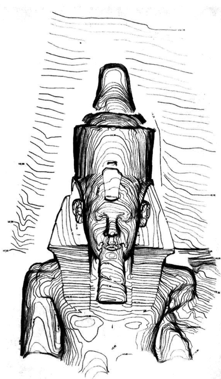
Fig. 39. — Cliché photogrammétrique de la partie supérieure d'un colosse d'Abou Simbel.
